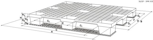
I **PALLET My-N BIS**, dotati di travette, sono più robusti e sono utilizzabili anche da carrelli elevatori con forche rotanti. Sono un'efficace soluzione ai problemi logistici in ogni realtà industriale o commerciale. Leggeri e resistenti, dotati di isolamento elettrico ottimale sono facilmente movimentabili e si prestano per un utilizzo intensivo. Mantengono la tara costante nel tempo e sono quindi ideali anche in impianti di imballaggio computerizzati.
